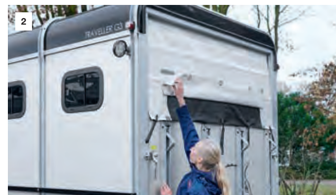
Bâche automatique avec enrouleur automatique [1] et filet intégré [2].
