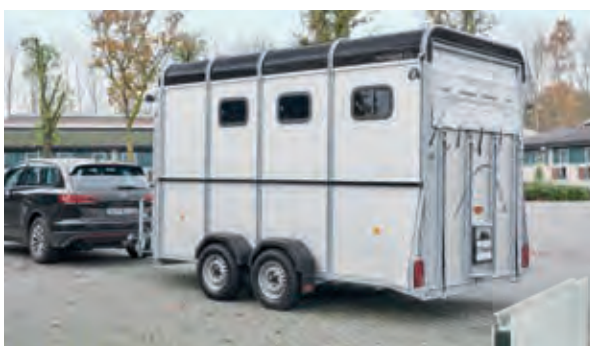
Carrosserie solide avec profilé aluminium anodisé à double paroi pour une sécurité accrue et une longévité à toute épreuve.
