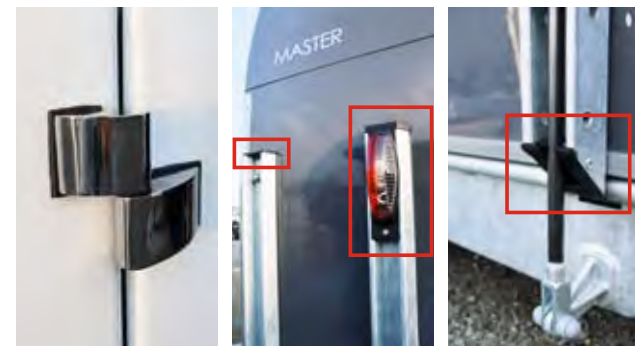
Absence absolue de coins et d'arêtes avec des charnières arrondies et des caches en plastique au niveau des charnières en acier profilés et aux extrémités des charnières de pont arrière.
