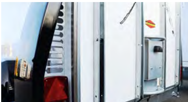
Pas de dérapage des sabots et bonne visibilité depuis la voiture grâce aux renforts arrières spécialement perforés.
