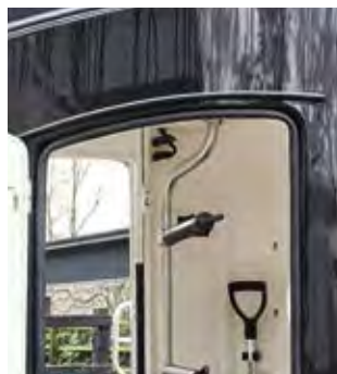
Protection contre la pluie avec des réglattes anti-pluie au-dessus des portes et dans la zone arrière.
