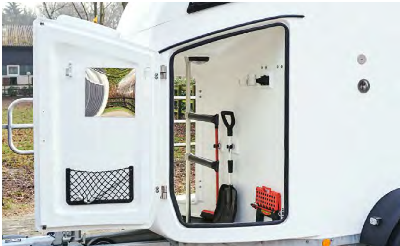
Utilisation simplifiée et vaste équipement standard du compartiment de sellerie avec arrêtoir de porte, balai télescopique, pelle en plastique, filet de porte, miroir, porte-cravache, mangeoires, grands crochets porte-bride, porte-tapis de selle, éclairage LED et un tabouret pliant avec dispositif de sécurité.
