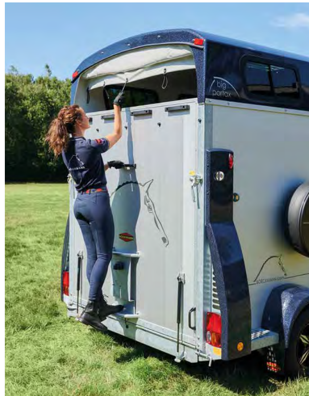
Utilisation facile grâce à l'enroulement facile de la bâche. Dispositif de levage pour une ouverture facile du pont arrière, avec dispositif de levage par 2 vérins encastrés.
