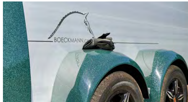
Garde-boue en guise de surface de rangement grâce à la forme large et droite en haut des garde-boues en plastique ou en polyester résistant aux chocs.
