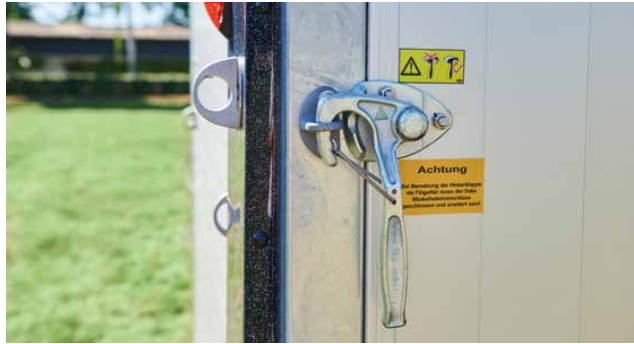
Sécurité grâce aux fermetures à levier coudé manœuvrables sur 180°, pour un risque de blessure réduit de votre cheval.
