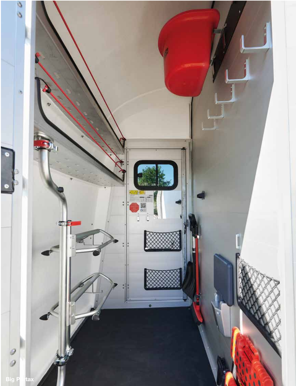
Equipement standard étendu Outre les porte-selles ou porte-selles professionnels réglables horizontalement et verticalement ainsi que les porte-selles extensibles, un balai télescopique, une pelle en plastique, un filet de porte, un miroir, un porte-cravache, des mangeoires, de grands crochets porte-bride, un porte-tapis de selle, un éclairage LED et un tabouret pliant avec dispositif de sécurité font partie de l'équipement standard (pces en fonction du modèle). Siège rabattable et tire-botte, de série sur le Portax L SR et sur le Big Portax.
