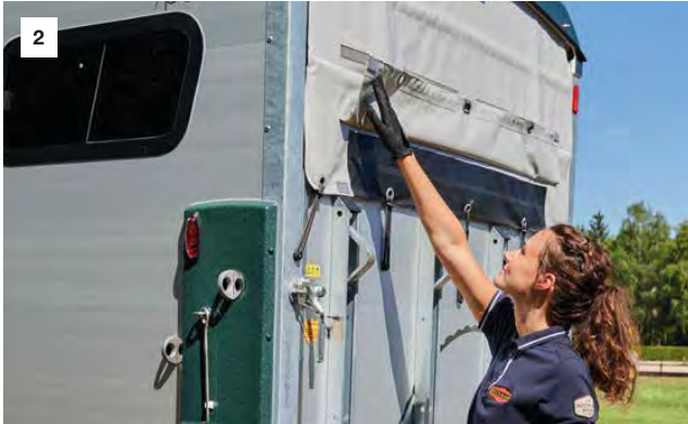
Bâche automatique avec enrouleur automatique [1] et moustiquaire intégrée (non disponibles sur les modèles Big Portax) [2].
