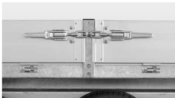
Poteau central (seulement MH-AL série) permet d'obtenir des ridelles divisées des deux côtés de la remorque. Option obligatoire lors du choix d'une bâche et arceaux.
