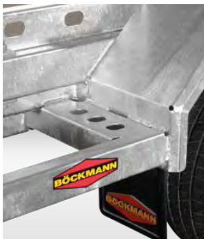
Marche-pieds avant et arrière de la protection de roue pour faciliter la montée et la descente.
