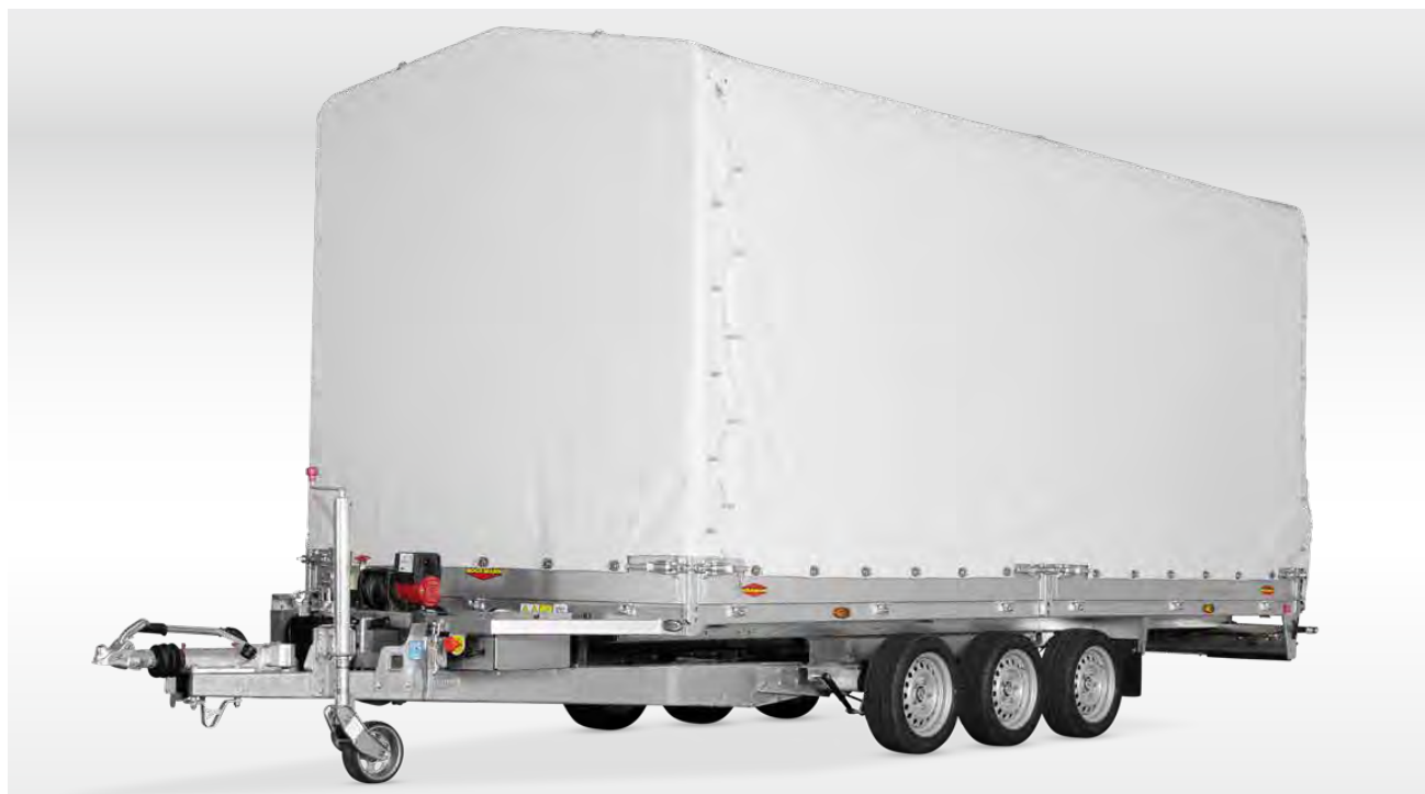
Bâche et arceaux (seulement MH-AL et TL-ALK séries) pour le transport protégé de véhicules, de machines ou d'autres marchandises (disponible pour les modèles MH sur demande). Les bâches sont proposées dans de nombreux coloris. Une marquage personnalisée est également possible, votre partenaire Böckmann local se fera un plaisir de vous conseiller !
