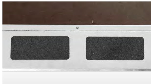
Protections de roues avec adhésif antidérapant et marquage du centre d'essieu
