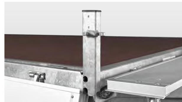
Ranchers corniers en acier amovibles par simple dévissage de la fixation.
